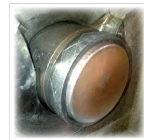
Pistone diam 160 mm, dopo 24.000 iniezioni. Produzione blocchi motore 4 cilindri
